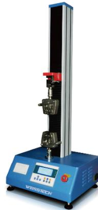
单柱拉力试验机 (WSLT-2KN)
