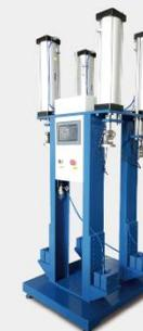
座椅气泵测试机
